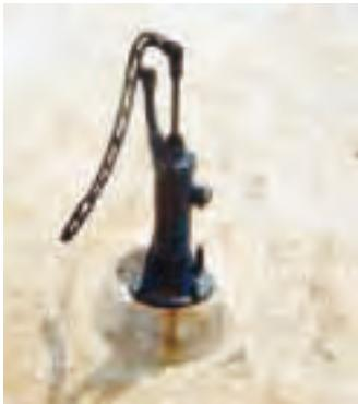
*Modelo sencillo de bomba manual. La manija es de movimiento semicircular vertical, lo que no permite movimiento inercial, es decir, cada movimiento hacia abajo (el que produce agua) necesita que el movimiento hacia arriba sea realizado con esfuerzo del brazo, aunque leve. En diferentes países hay variaciones del mismo modelo o más grandes. Se le conoce con el nombre de bomba catracha. Foto: Marcos J. Vieira.*
