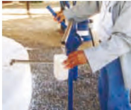
*Modelo manual sencillo, similar al anterior. La manija es de movimiento semicircular horizontal sin movimiento inercial, es decir, cada movimiento hacia un lado (el que produce agua) necesita que el movimiento contrario sea realizado con esfuerzo del brazo, aunque leve. Hay en el mercado modelos más grandes. Foto: Marcos J. Vieira.*
