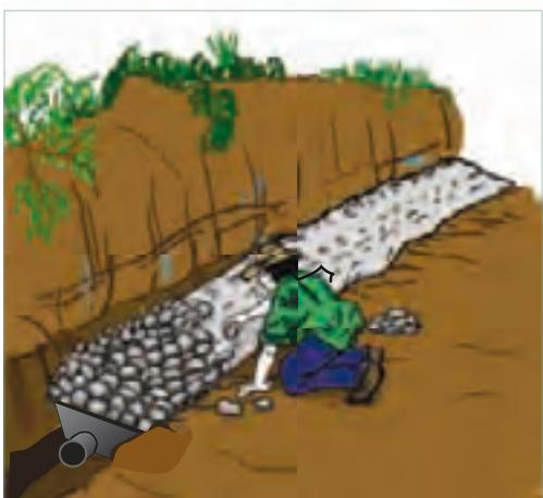
Una nueva capa de piedras más pequeñas es colocada por encima de la lámina plástica con la finalidad de fijación y protección. Se pueden fraguar las piedras como cobertura. La salida del tubo se conecta a un tubo de conducción primario hasta un estanque de derivación construido aguas abajo.
